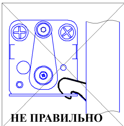
Рис.16А Вид на механизм фиксации изнутри короба. Рама кровати в вертикальном положении.
