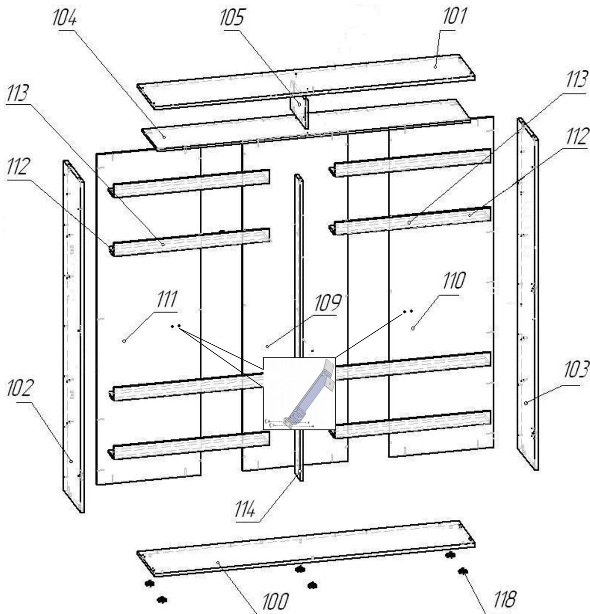
Разметить отверстия для закрепления короба к стене комнаты в стенках задних (в каждой не менее двух точек выше середины). КООРДИНАТЫ ТОЧЕК ВЫБИРАТЬ ИЗ МАКСИМАЛЬНОЙ ПРОЧНОСТИ УЧАСТКОВ СТЕНЫ.
