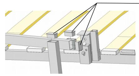
10. Присоединить к раме нижнего яруса щит кровати поз.117, в четырёх точках в соответствии с рисунком, используя винты М6х14 поз.43 и Шайбу 8,5х24х2 поз.63.
