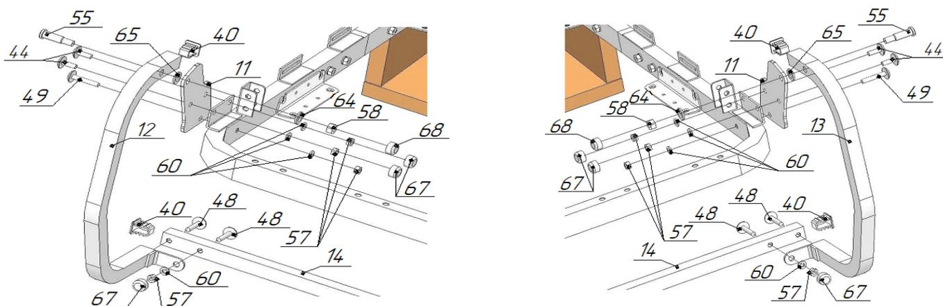
5. Разрезать пополам наклейки войлочные поз.38 и приклеить к штанге опоры поз.14 в соответствии с рисунком.
