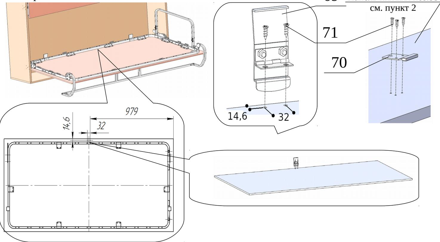
13. Установить магнит с резьбовым стержнем М4 поз.61В на опору правую поз.13. Установить фиксатор поз.61 на щит декоративный поз.117 с помощью шурупа-самореза d4x16 поз.61А (Шуруп до упора не закручивать). Подвинуть фиксатор поз.61 к опоре правой поз.13 таким образом, чтобы магнит с резьбовым стержнем М4 поз.61В примыкал к шайбе фиксатора. Закрутить шуруп-саморез d4x16 поз.61А до упора. Окончательно закрепить фиксатор поз.61 саморезом поз.61Б.
