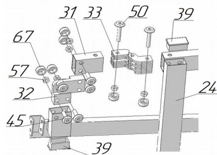
8. Присоединить собранную лестницу к раме верхнего яруса в соответствии с рисунком, используя винты М6х25 поз.45, гайки М6 со стопорным кольцом поз.57 и колпачки пластмассовые малые поз.67. В нижние торцы лестницы поз.24 установить ножки поз. 41.
