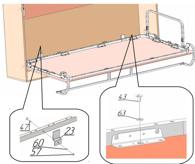
11. поз.125. Аналогично предыдущему пункту установить щит кровати верхний поз.116 к раме верхнего яруса, обеспечив зазор между щитами декоративными — 10 мм, стенками короба — 5 мм.
