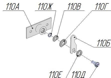
Рис.2.8 Фиксатор в сборе поз.110 для установки справа
