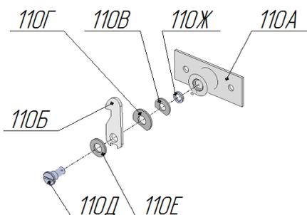
Рис.2.7 Фиксатор в сборе поз.110 для установки слева
